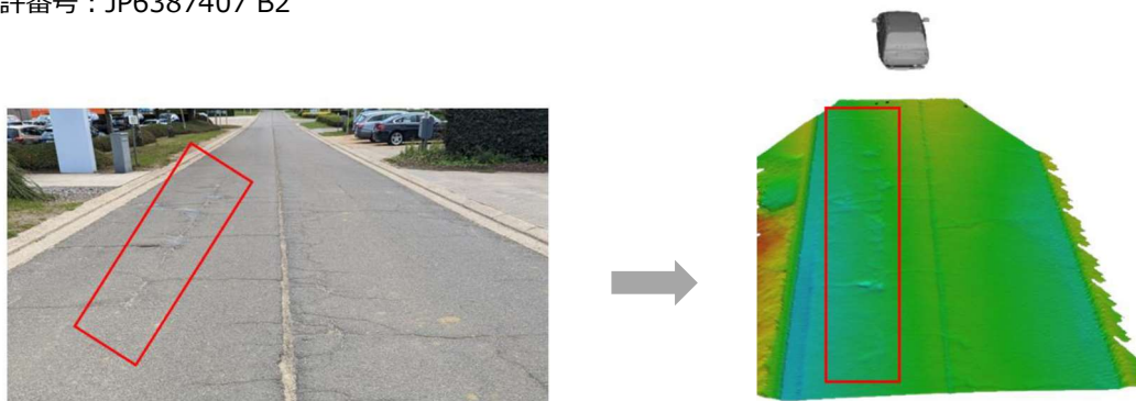
2 車線分の路面凹凸をデジタル化（イメージ）
