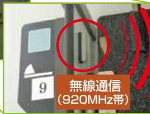
扉開閉センサー 特定省電力テレメータ(汎用品)
